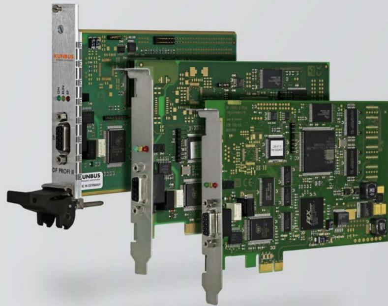
BUS配置到板卡。舒适而全面的图形界面减轻了您网络组态的工作负担。全面的下载、分析和控制功能允许您有效地检查已配置的 PROFIBUS DP 网络，编译后的配置以 XML 格式存储，这也方便您结合第三方应用去使用。
