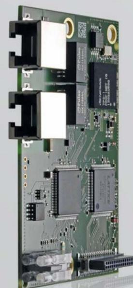
高性能的 KUNBUS-COM 通信模块为您提供了一种简单且节省成本的选择，可将现场总线或工业以太网网络集成到您的设备中，而无需内部耗时的开发工作。
