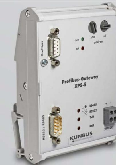
XPS-E网关能够轻易可靠地将串口设备 (RS232、RS422以及RS485) 集成进PROFIBUS DP网络中; 串口同样适用Modbus ASCII以及Modbus RTU设备。
