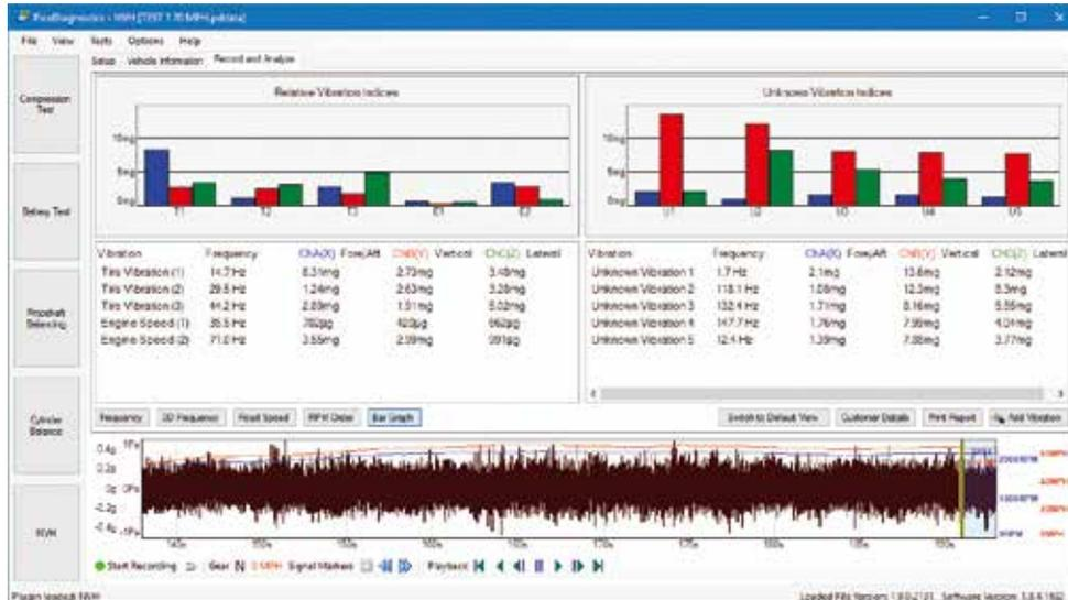
当你更加精通PicoDiagnostics软件时，如果需要，你可以增加额外的振动阶次。E(Engine, 即发动机)、T(Tire, 即轮胎)和P(Propshaft, 即传动轴)指的是软件正在分析的旋转部件，并且在每种情况下，都有一个数字后缀。这个数字指的是每个记录事件的振动阶次(该部件每旋转一周其振动所发生的次数)。下面这张图显示一个轮胎存在径向跳动，每旋转一周会产生一次振动。这叫做第一阶次轮胎震动，或者在软件上显示为T1。
