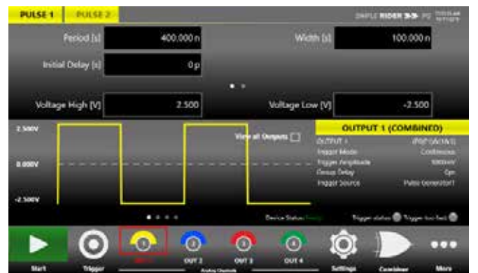
图2 简洁的Rider用户界面，两个窄脉冲生成 (5ns)，有7.5ns延迟分别。
