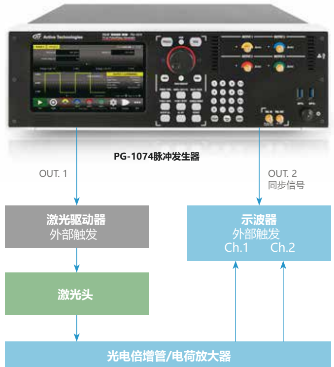
图1 光电倍增管/电荷放大器测试和表征设置原理图
